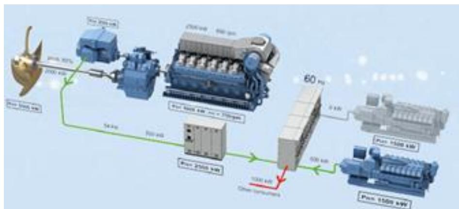
Figura 15 - Modo de operação Paralelo (Fonte: Rolls Royce).
