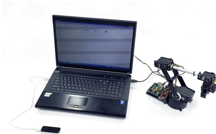
Figura 1. Protótipo composto pelo Leap Motion conectado ao PC, e este por sua vez conectado ao braço robótico
